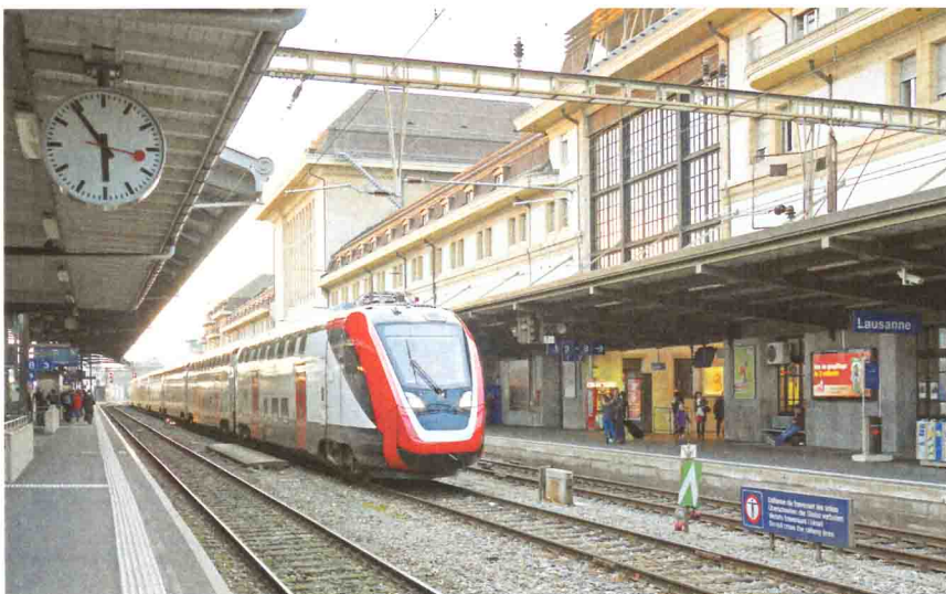
Rame d'essai du nouveau train à 2 étages (TWINDEXX Swiss Express). Le choix de ces rames nécessite la prolongation des quais à une longueur de 450 mètres. Lausanne, 26 février 2016.
